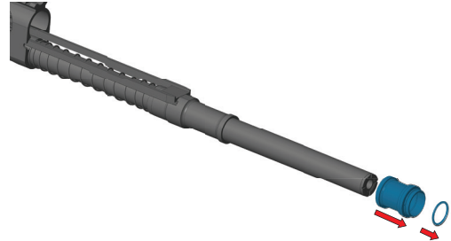
Şekil 15d: Silindir lastik contası ve pistonun çıkarılması
